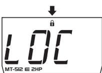
Para desbloquear, desligue o controlador e volte a ligá-lo com a tecla **[F]** pressionada. Mantenha a tecla pressionada até que a mensagem **[LOC]** apareça. Ao soltá-la, a mensagem **[FFF]** será exibida no display.
